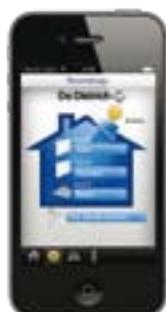
6. • Visualisation des circuits actifs de l'installation Possibilité de nommage des circuits
